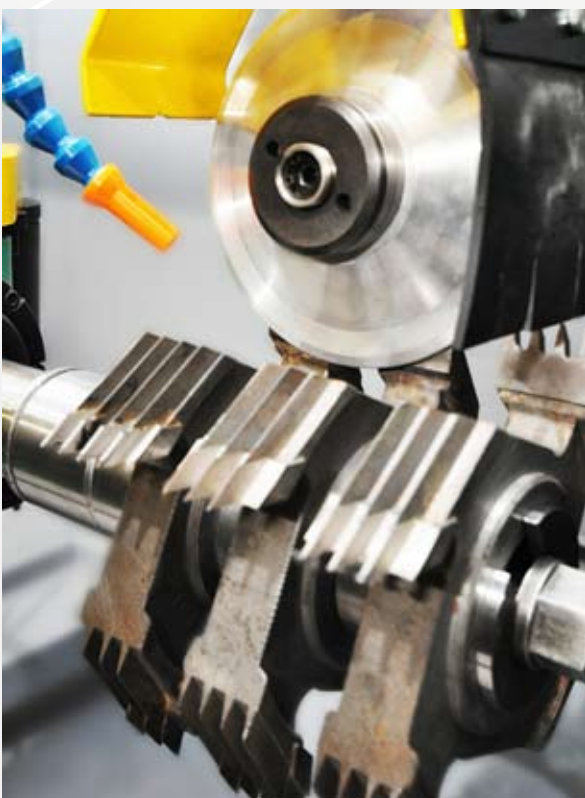
Afiação de fresas e finger joints
